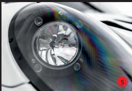
XENONSCHINWERFER INKL. LED SPOTS* Hochleistungsscheinwerfer inkl. Polycarbonat Cover
