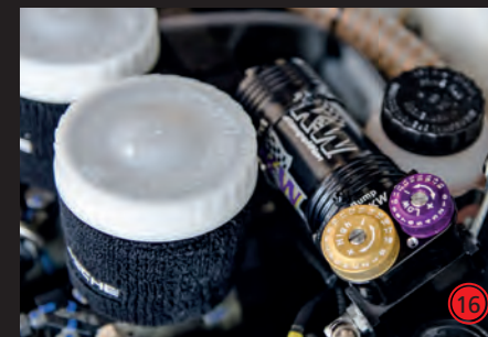
RENNSPORTFAHRWERK 3-FACH EINSTELLBAR* Unabhängig einstellbar in Zug- und Druckstufe mit Linearlagerung in Verbindung mit Hochleistungsrennsportfedern
