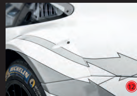
CARBON RADHAUSVERBREITERUNG HA Leichtbauverbreiterung zur Abdeckung der erhöhten Spurweite
