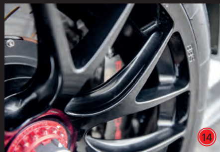
SCHMIEDERÄDER* Einteiliges Leichtmetall-Schmiederad, 12,0J x 18 ET17 und 13,0J x 18 ET37,5 mit Zentralverschlussanbindung
