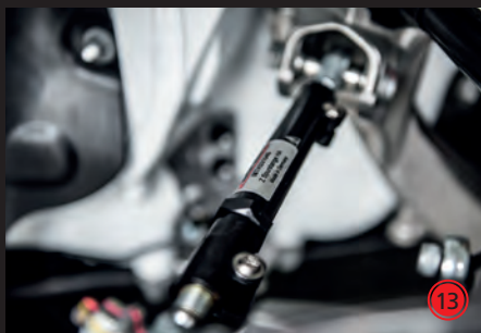
LENKERKIT HA Spur- und Sturzlenker aus hochfestem Aluminium inkl. Hochleistungsgelenklager
