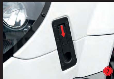
SCHNELLVERSCHLUSS FRONTSTOSSSTANGE Verschluss zur schnellen Abnahme der Frontstoßstange
