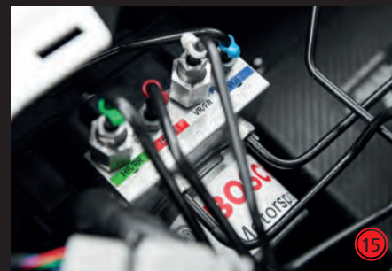
ABS SYSTEM 12-FACH EINSTELLBAR* Verstellbar durch Drehregler in der Mittelkonsole
