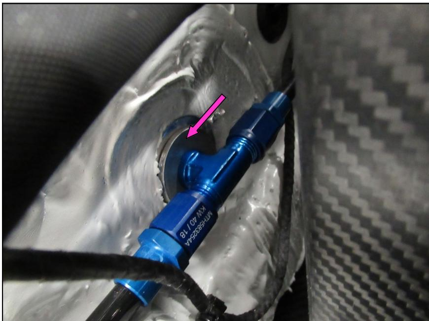
Legen Sie von innen (im Fußraum Beifahrerseite) die Unterlegscheibe (Pos.18) an.
